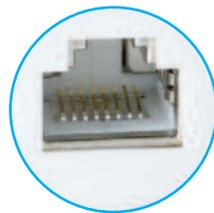
als Standard RJ 45-Anschluss jederzeit als Wartungs- oder Programmierschnittstelle geeignet
