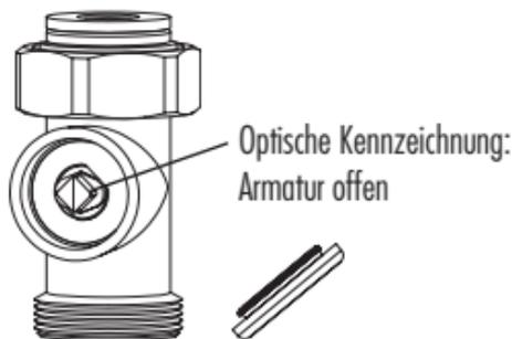
Bild 1: Armatur Durchgangsform offen
