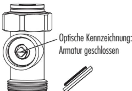
Bild 2: Armatur Durchgangsform geschlossen
