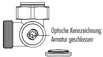
Bild 4: Armatur Eckform geschlossen
