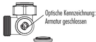
Bild 4: Armatur Eckform geschlossen
