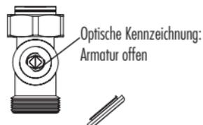
Bild 1: Armatur Durchgangsform offen
