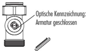
Bild 2: Armatur Durchgangsform geschlossen
