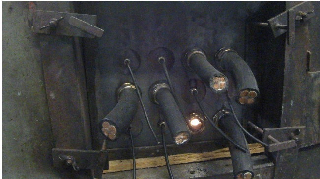
Nach ca. 26.5 Minuten – Versuchsende After approx. 26.5 minutes – End of test
