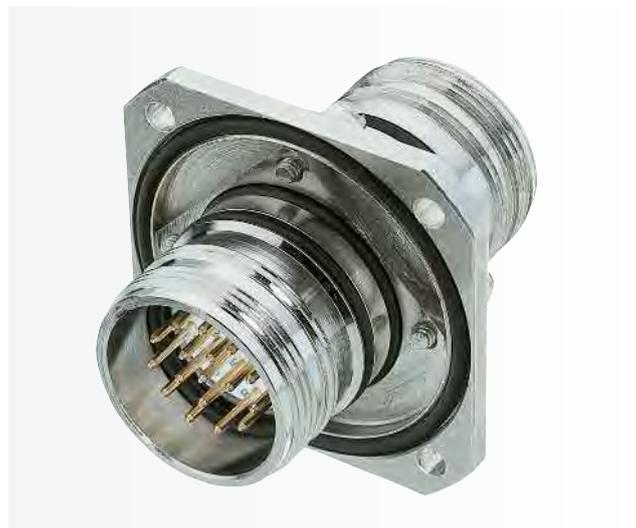
Ce passage de cloison M23 est livrable avec les isolants de 6 à 19 pôles. Très robuste, il est étanche à l'eau lorsqu'il est monté.
