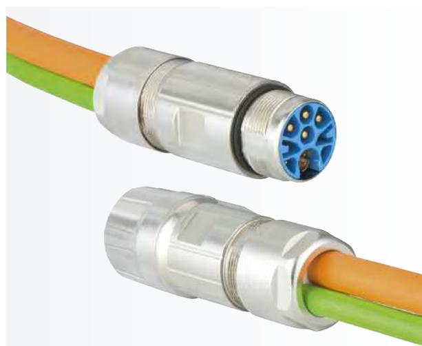
При помощи мультिवставки в одном штекере объединены силовой кабель Cat5e и сервокабель. Быстрозащёлкаваемый разъём имеет класс защиты IP 67.
