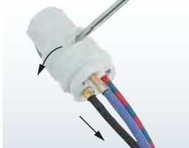
**Закрепление экранирующей оплетки**
