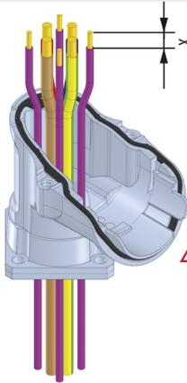
⚠ x Kontakt  $\varnothing$  2 mm = max. 7 mm Abisolierlänge
